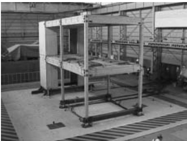
図-8 複合システムの実大振動実験写真(左:2層の試験体、右:接合部の破壊状態)
