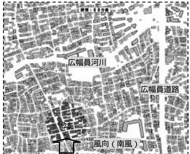
図 5 現版延焼シミュレーションモデルによる延焼拡大 (×: 出火点、経過時間: 60 分)
