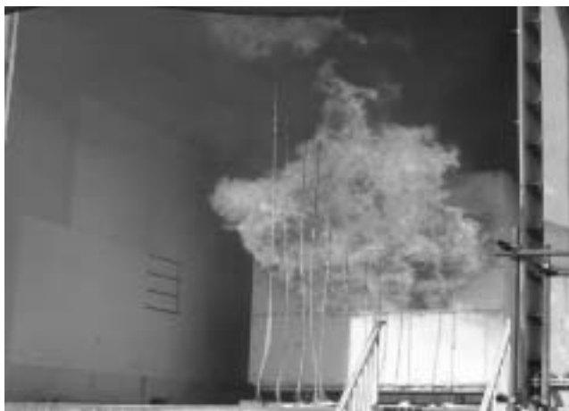
写真 火災風洞実大実験における有風下開口噴出火炎 (図1の×にて実施)
