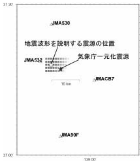
図3 深さ10.5 kmにおける波形の残差変化分布,濃い色の点ほど観測波形が再現されている事を示す.
