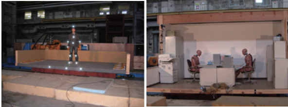
図4 大ストローク振動台を利用した実験
