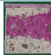
モルタル塗り仕上げ 中性化深さ測定例
