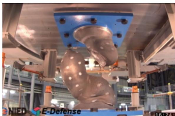
図 22 鉛ダンパーの二方向加振実験(長時間加振による破断)
