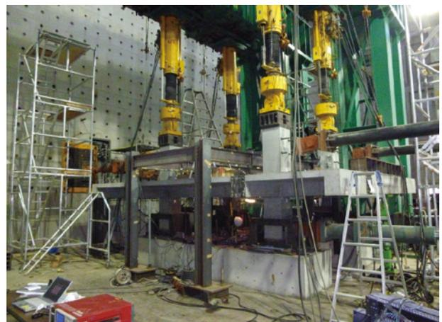
図18 RC造部分架構実験
