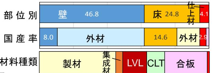
図5 枠組壁工法6階建て実験棟の木質資材量(数値はm<sup>3</sup>)
