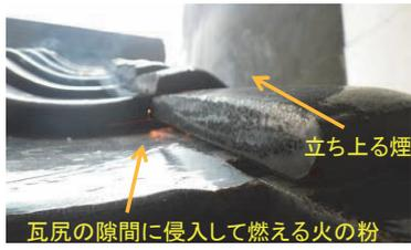
写真4 風速 10 m/s 実験時の瓦屋根上部
