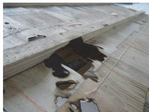
屋根下地に付いた火の粉の着床によるとみられる焦痕の数を数えた。実験は屋内側への延焼が確認された時点（写真6）で、消火、解体を行っており、また焦痕面積は考慮せず、写真7のように焦げ広がった部分の焦痕数は1とした。図9に焦痕の分布と数を記す。風速が上がるにつれて焦痕の数が増加することが分かる。また軒先から棟までの段数ごとに集計した数を比較すると、風速 5 m/s では全体に均等に散らばっているのに対し、風速 10 m/s では棟に近い側で焦痕が増加していることが分かる。これは棟付近での燃え抜けが多くみられた現地調査結果と符合する。今回の実験では瓦の隙間は軒と棟で大きな差はなく、また瓦下部には瓦を銅線で吊るための瓦棧が水平方向に通っており瓦下侵入後に火の粉が棟部に吹き寄せられたとは考えにくいので、瓦上部において棟の立ち上がりの影響で棟付近の方が火の粉が吹き溜まりやすく、結果として瓦下部に侵入する火の粉も多くなったと考えられる。
