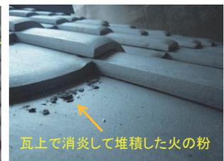
写真9 瓦上で消炎して堆積した火の粉
