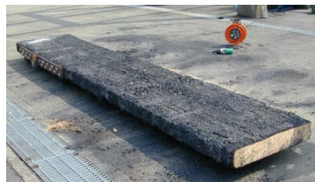
火災加熱を受けた大断面集成材の梁
