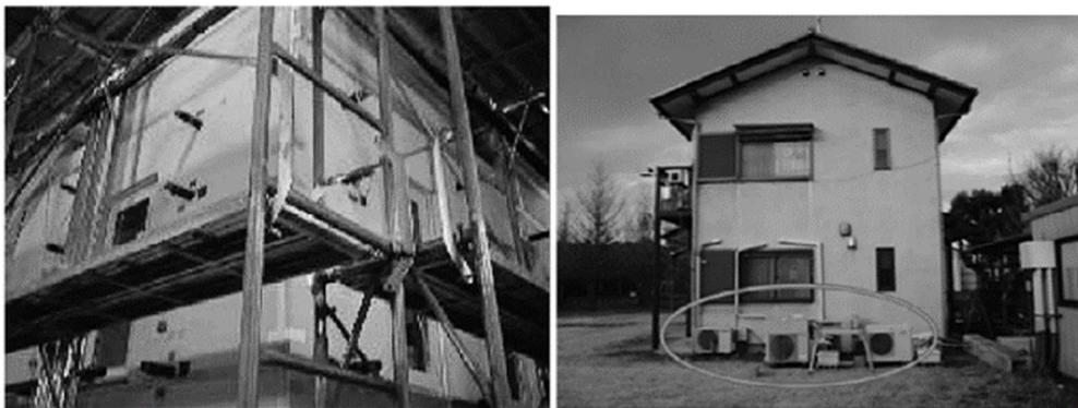
図11 ヒートポンプ機器の計測（建築研究所）（左：実験室実験、右：実験住戸における実測）
