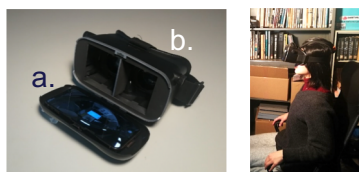
図1 HMD型VRシステム 4) 評価の様子 (a. iphone 14pro, b. Urgod goggle)
