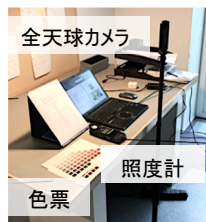
図3 全方位測光色測定
