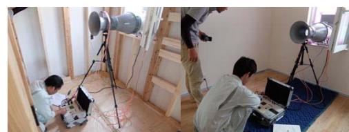
左：施工過程気密検査 右：完了器気密検査
