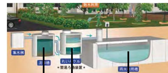
集水槽 沈砂槽 ろ過装置 雨水貯留槽
